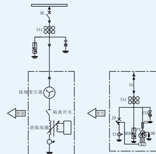
3. 替代消弧线圈接入系统
