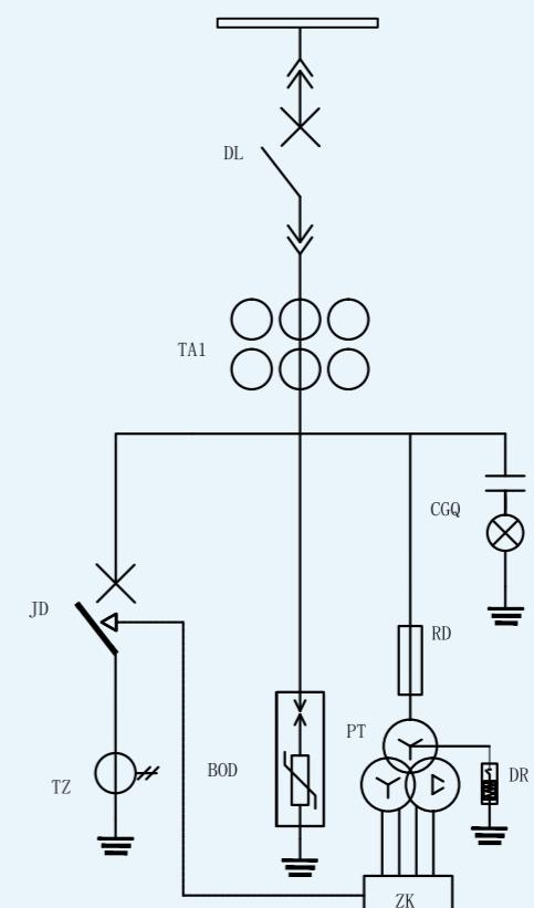
DL—真空断路器、TA1—电流互感器、JD一分相接地开关、TZ—零序电流互感器
